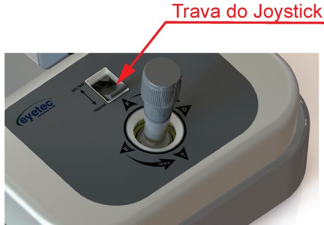
Figura 11 – Posição da trava de posicionamento
