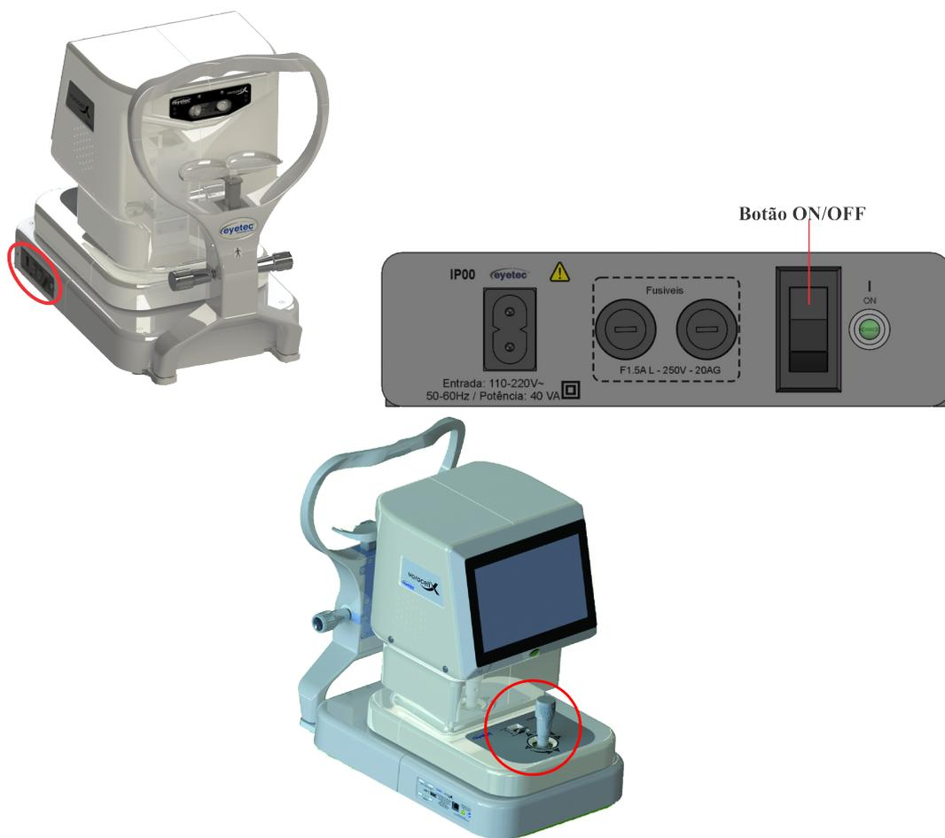
Figura 7 – Posicionamento dos botões de energia do Equipamento
